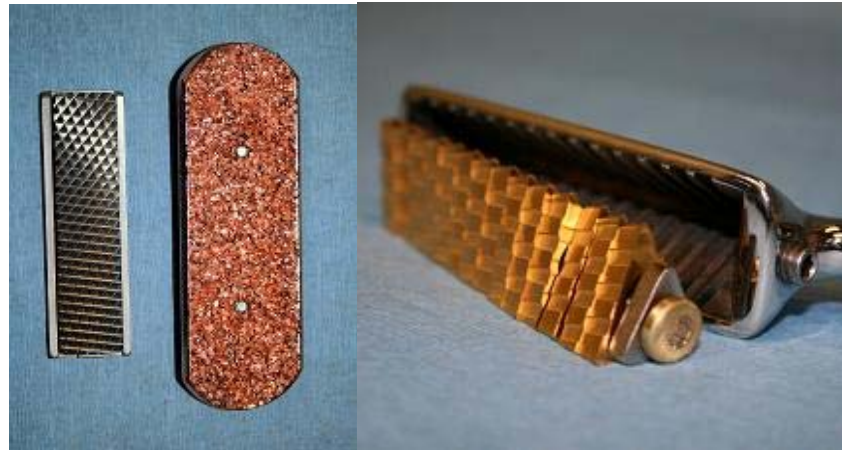
KUVA 13 Vasemmalla keskikarkea kovametalliterä ja kovametallisiterä. Oikealla titanitriidikovametalliterä pyramidiraspissa. (Kuva Iina Brotherus)
